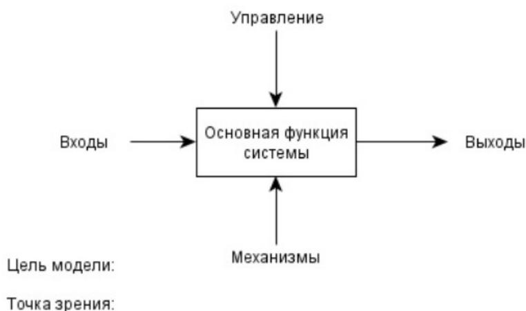
Рис. 4.7. Базовые элементы SADT модели
