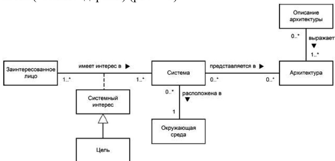
**Рис. 4.1. Контекст определения системы**
